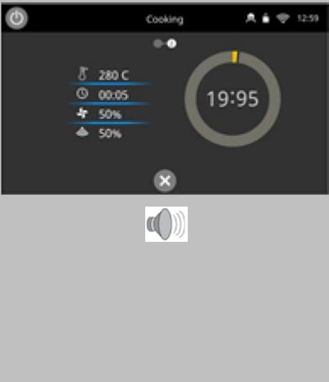
Il timer di cottura esegue il conto alla rovescia fino a zero ed emette un segnale acustico per avvisare l'operatore che è richiesto il suo intervento al termine del profilo di cottura o di una fase del profilo. Una volta ultimato il profilo di cottura, aprire lo sportello ed estrarre l'alimento dal vano.
